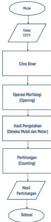
Gambar 4.1. Diagram Alur Proses Aplikasi Deteksi Jumlah Kendaraan Bermotor Melalui Video CCTV
