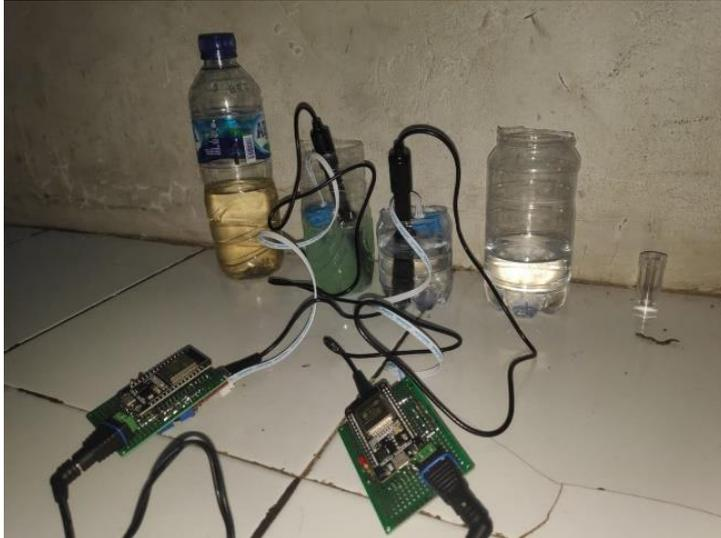
**Gambar 9.** Sensor keasaman (kiri) dan sensor kekeruhan (kanan) yang terangkai pada Mikrokontroler ESP32.
