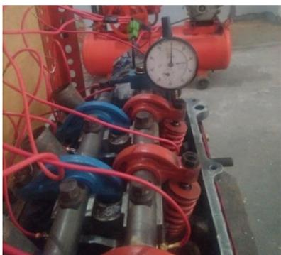
Gambar 1. Pengukuran menggunakan dial indikator
