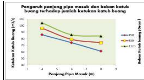
Gambar 5 Grafik pengaruh panjang pipa masuk dan beban katub buang terhadap jumlah ketukan katub buang
