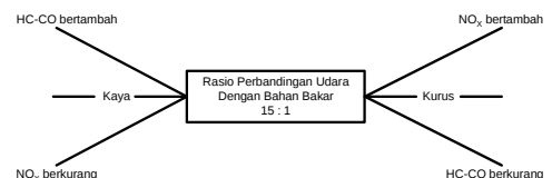
Gambar 6. Rasio Perbandingan Antara Udara dengan Bahan Bakar Terhadap Kadar HC, CO, NO_x
