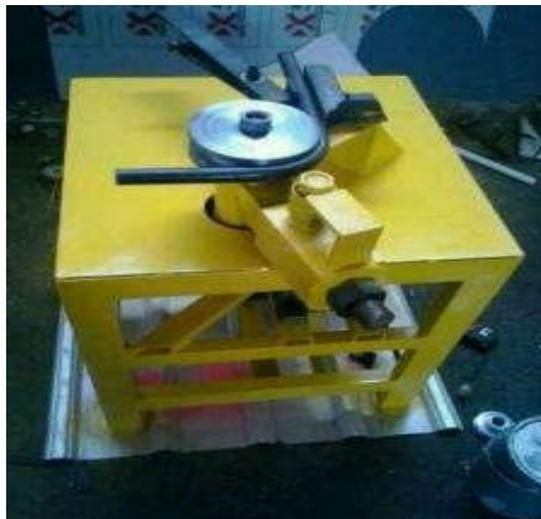
Gambar 4. Alat Pembengkok Pipa Besi
